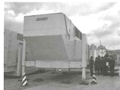
報告会の前に、スポンサーである(株)興研が所有する自揚型移動式高圧発電装置と集散自在の電力供給システムを見学。
